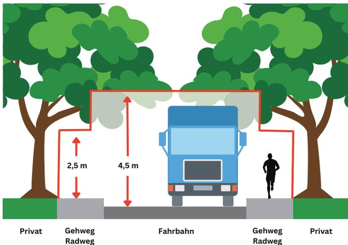
Über Geh- und Radwegen ist eine **Höhe von 2,5 Metern** und über Fahrbahnen eine **Höhe von 4,5 Metern** freizuhalten.
